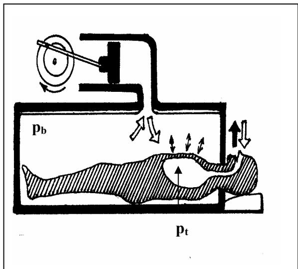
Az ábra a légzésbénult betegek tartós mesterséges lélegezetését biztosító szerkezet, a „vastüdő” működését mutatja be. A  $p_t$  és  $p_b$  betűjelések a megfelelő üregben mérhető nyomást jelölik.
